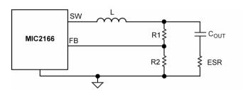
Figure 8a.  $\frac{R2}{R1+R2} \times \Delta V_{OUT} > 20 \text{mV}$
